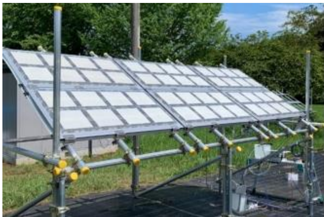
図5 3m 2 規模の光触媒パネル反応器（左）と100m 2 規模の光触媒パネル反応器から生成した水素と酸素の混合気体（右）
