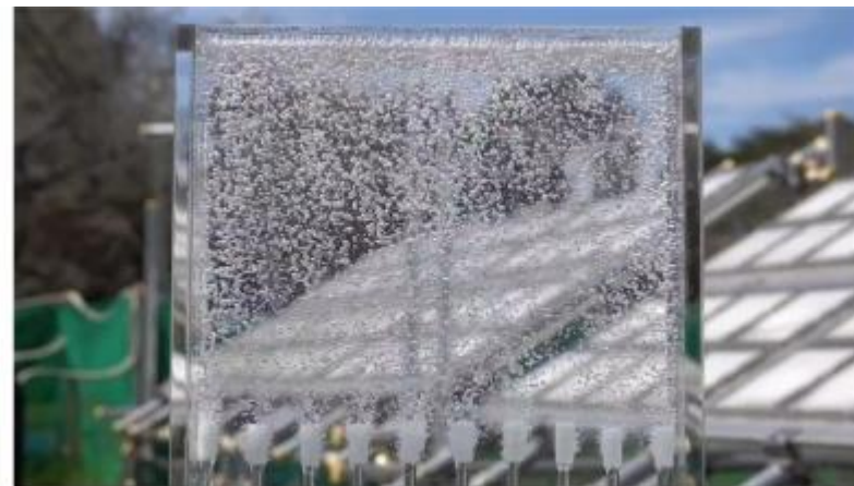
図5 3m 2 規模の光触媒パネル反応器（左）と100m 2 規模の光触媒パネル反応器から生成した水素と酸素の混合気体（右）
